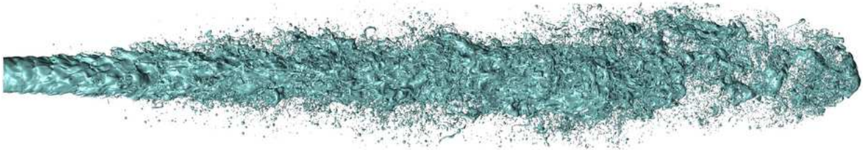
FIGURE 5 – Visualisation instantanée de l'interface liquide/gaz dans le cas DNS.
